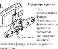
3. Установите кронштейн на стойке части А и винт ( М ), как показано на рисунке.
