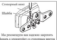
Мы рекомендуем вам надежно закрепить фонарь к кронштейну со стопорным винтом для предотвращения кражи.
